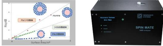
測定例：三種の微粒子分散体の分散性評価一例
