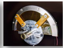
配管へのモジュール設置例
