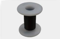
100m以上の長距離系化技術 (熱電発電素子：CNT系)
