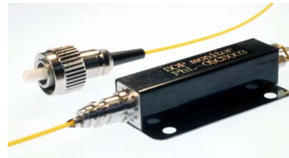
(a) (b) 例1. 次世代高速光通信用小型・高精度DOPモニタ
